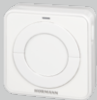
Majasisene raadio- seinalüliti FIT 2-1 BS 2 funktsiooniga, kuni maksimaalselt 2 juhtelemendi ühendamise võimalus kaabli abil, nt võtilüliti
